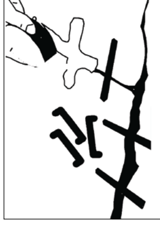
Рис. 3.3 Наложение скоб на стяжку и закрытие трещин силовым замканием
