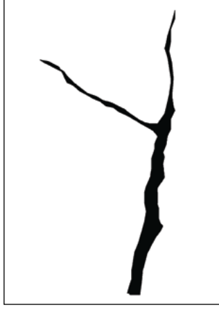
Рис. 3.1 Трещины в стяжке
